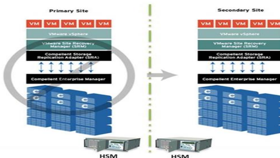
Figura 4 Schema logico della soluzione di Disaster Recovery
